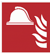
Neue Kennzeichnung („Mittel und Geräte zur Brandbekämpfung“)
